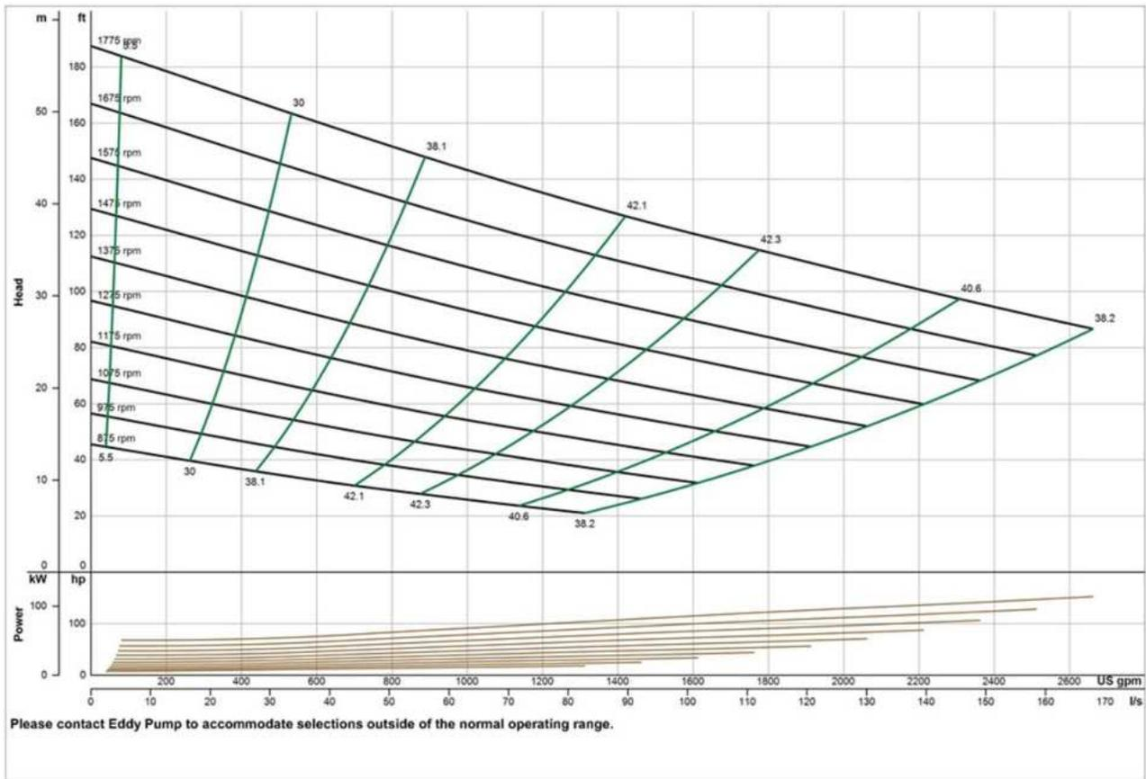
\*Curva general de la bomba basada en agua con un motor de 1200 RPM. Háblenos de sus materiales específicos para una curva a medida.
